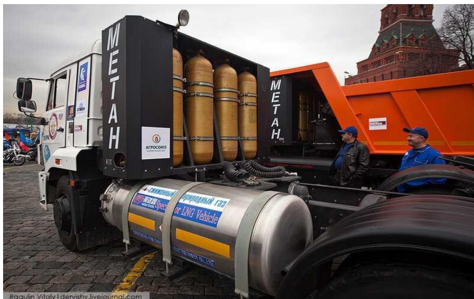
1.2 - сурет – Дизельді қозғалтқышы бар автомобильдердің газбен жұмыс істеуіне арналған отынмен қоректендірудің газдизельді жүйесінің орыны
